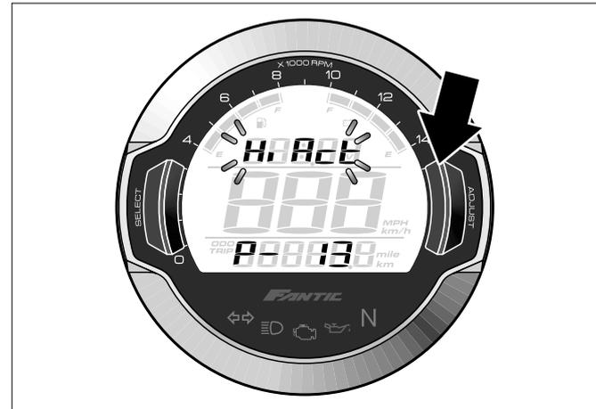
**!** Bei Leerlaufdrehzahl des Motors prüfen, ob die Drehzahlanzeige eine Stufe anzeigt und ob sie bei einer leichten Gasdrehung zwei Stufen erreicht. Ist dies der Fall, ist die Konfiguration korrekt, sonst muss sie wiederholt werden.
