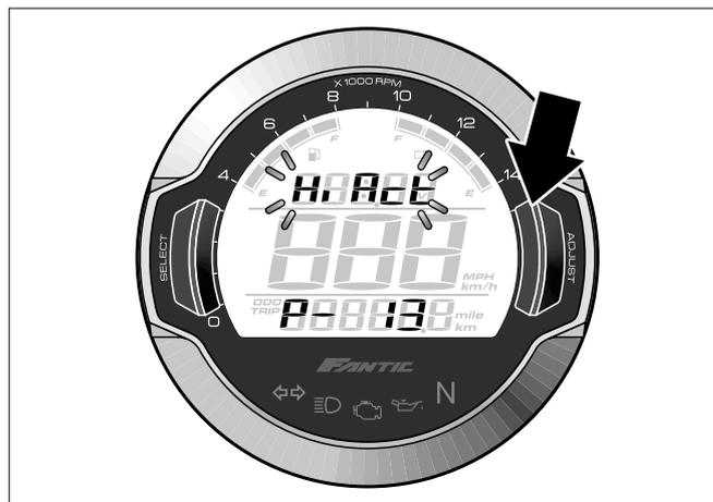
⚠ Vérifiez avec le moteur au ralenti si l'indicateur RPM indique une encoche et si, avec une légère rotation du gaz, il en indique deux. Dans ce cas, la configuration adoptée est correcte, sinon réessayez.
