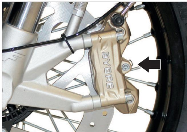
Um den Abstand zwischen Bremsscheibe und Bremsbeläge einer Sichtprüfung zu unterziehen, blicken Sie beim vorderen Bremssattel von unten nach oben und beim hinteren Bremssattel von oben in Richtung der Radnabe.
