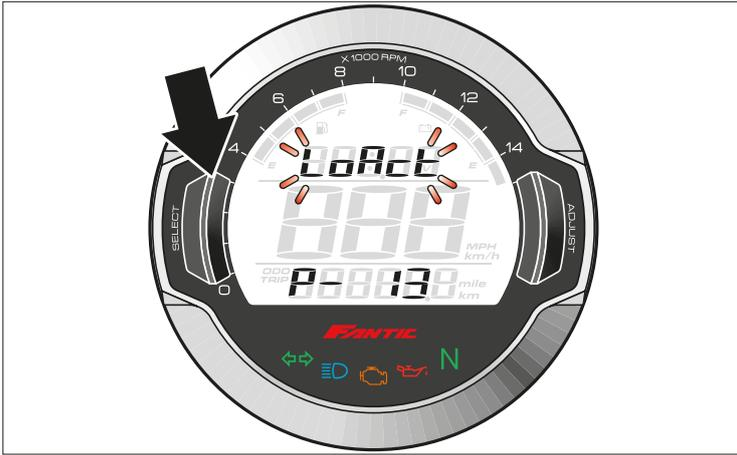
**!** Bei Leerlaufdrehzahl des Motors prüfen, ob die Drehzahlanzeige eine Stufe anzeigt und ob sie bei einer leichten Gasdrehung zwei Stufen erreicht. Ist dies der Fall, ist die Konfiguration korrekt, sonst muss sie wiederholt werden.
