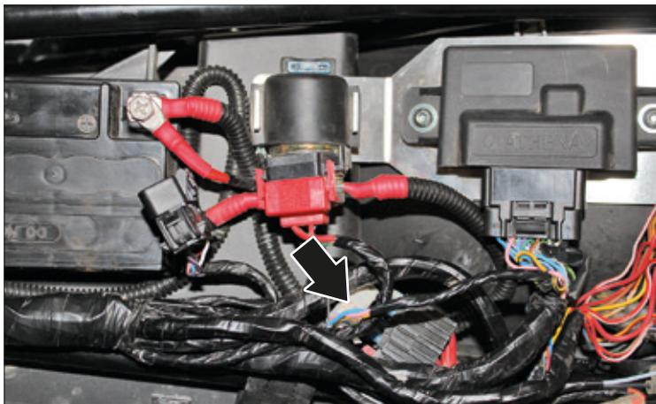
Der Programmierstecker des Einspritz-Steuergeräts befindet sich unter der Sitzbank zwischen Steuergerät und Sicherungskasten.
