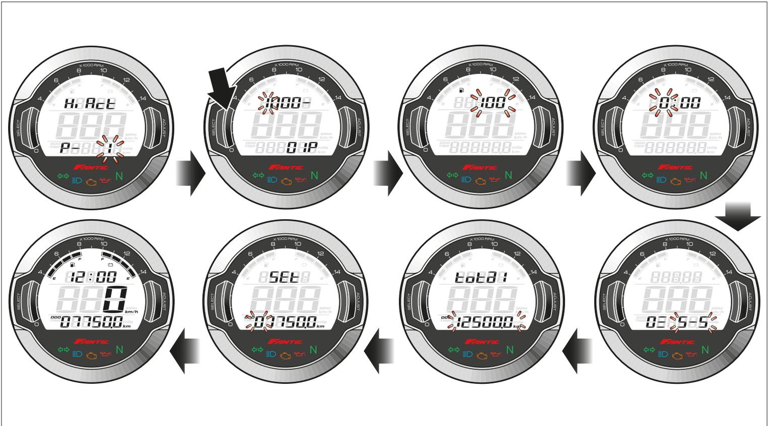
Aus der Menüseite der Einstellungen gelangt man durch Druck der Wähltaste („SELECT“) zu folgenden Einstellungen: Die Menüseite der Einstellungen bietet der Reihe nach folgende Einstellmöglichkeiten:
