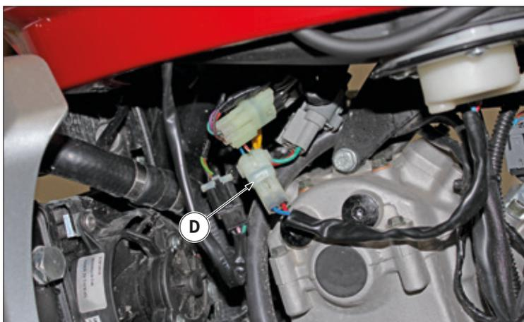
Den Steckverbinder „D“ der Kraftstoffpumpe vom Hauptkabelstrang abziehen.
