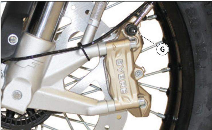
Den Anschluss der Bremsleitung „G“ am Vorderrad-Bremssattel entfernen und die Leitung ausbauen.
