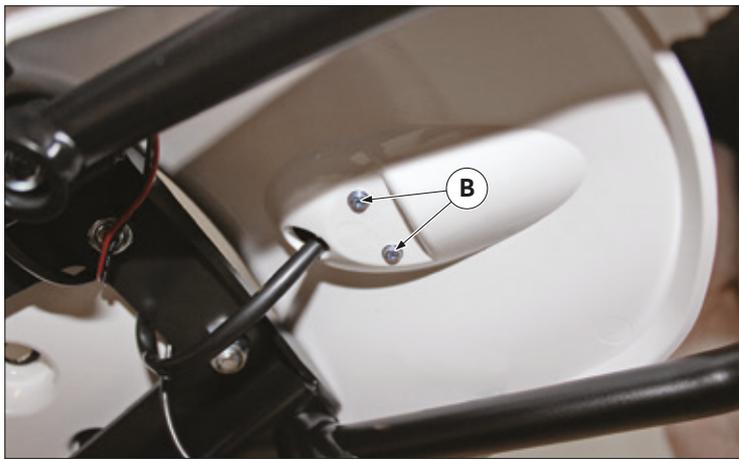
Die Befestigungsschrauben „B“ lösen und das Rücklicht „C“ ausbauen.
