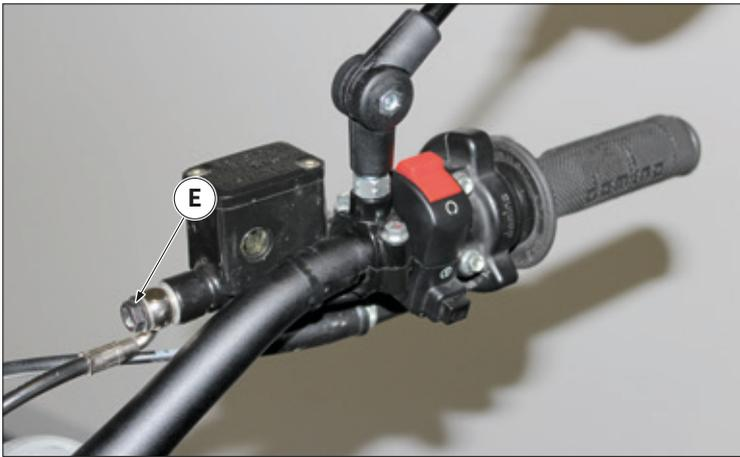
Den Anschluss der Bremsleitung „E“ an den Hauptbremszylinder des Vorderrads entfernen und die Leitung ausbauen.
