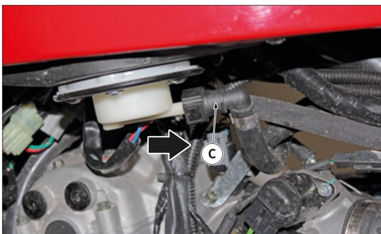
Den Gummischlauch „C“ von der Kraftstoffpumpe abziehen.
