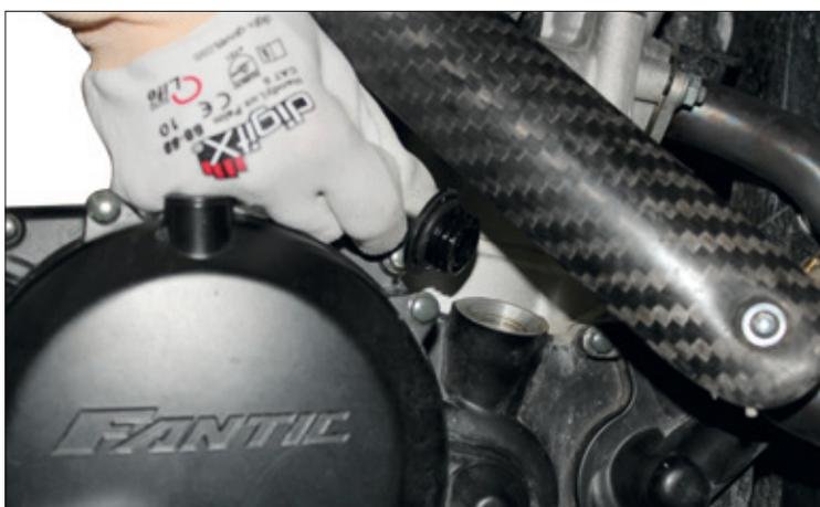
Mit dem Messbecher 1500-1600 ml Öl abmessen und durch die Einfüllöffnung am Kupplungsdeckel in den Motor einfüllen.
