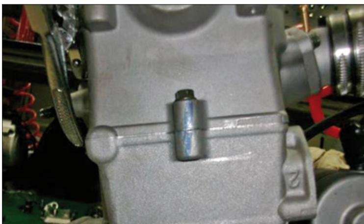
Die M6x25 Schrauben von Zylinderblock und Zylinder in die Bohrungen einsetzen und festziehen.
