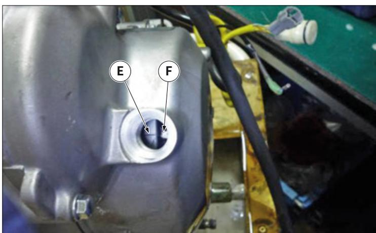
2. Die Befestigungsmutter des Lichtmaschine mit dem entsprechenden Sonderwerkzeug durchdrehen und prüfen, ob die Steuerzeitenmarkierung „-“ am Rotor der Lichtmaschine „E“ mit der Steuerzeitenmarkierung links am Gehäuse und in der Mitte „F“ fluchtet.
