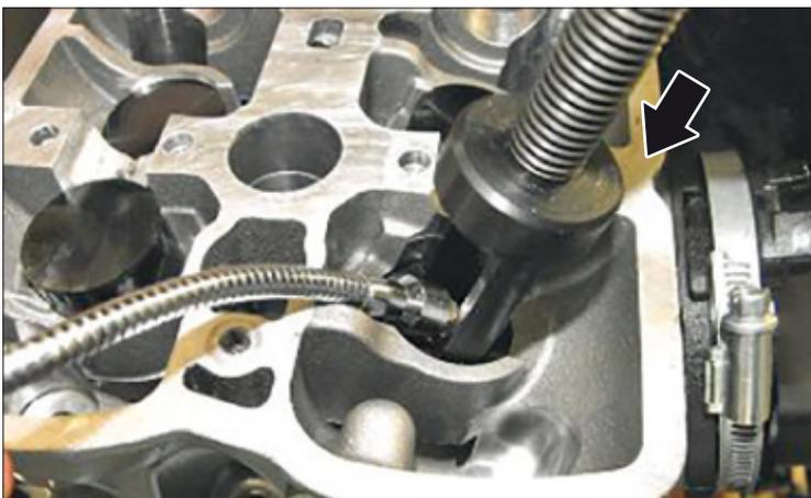
Die Feder mit einem Ventildertellerspanner zusammendrücken, und dann die Kegelstücke in die Feder einsetzen.
