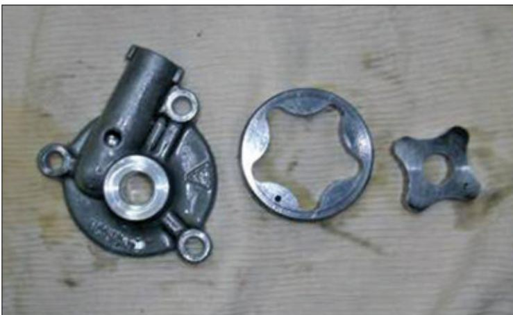
**13.6.19 Inspektion der Ölpumpe der rechten Seite des Motorblocks**
