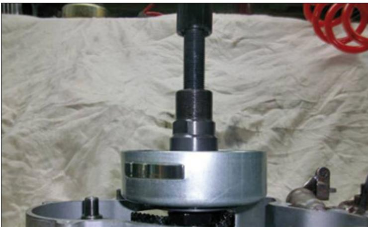
**13.7.3 Ausbau des Rotors der Lichtmaschine**
