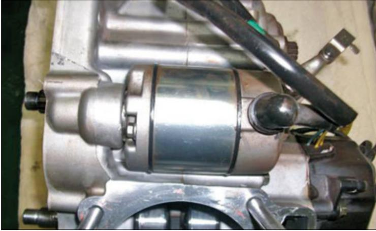
**13.6.8 Ausbau des Startermotors**
