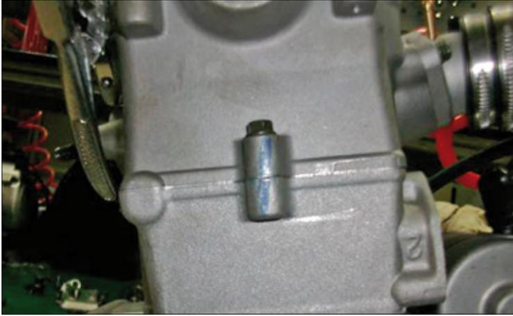
Die Schraube M6×25 von Zylinderkopf und Zylinderblock lösen.
