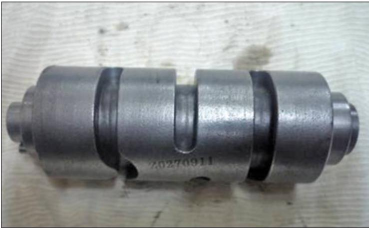
Prüfen, ob die Oberfläche der Schaltwalze und die Nuten verschlissen oder beschädigt sind.
