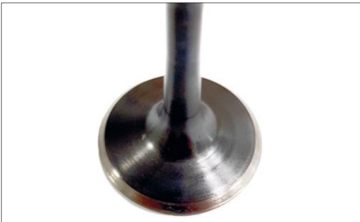
Prüfen, ob durch das Nachschleifen die Abdichtung zwischen Ventil und Ventilsitz erhalten wurde. Andernfalls das Nachschleifen wiederholen. Falls kein zufriedenstellendes Ergebnis erzielt wird, ein neues Ventil oder einen neuen Zylinderkopf einbauen.
