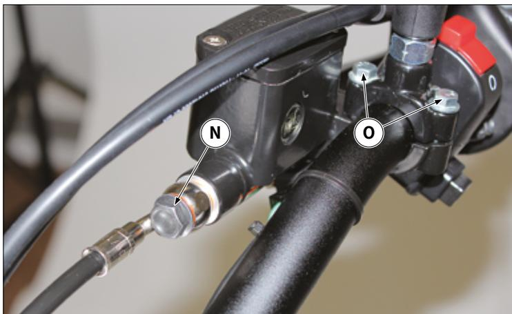
**12.18.6 Rimozione pompa freno anteriore**
