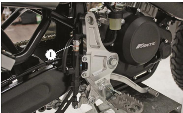
Rimuovere il raccordo tubazione impianto frenante “I” sulla pompa freno posteriore e rimuovere la tubazione.
