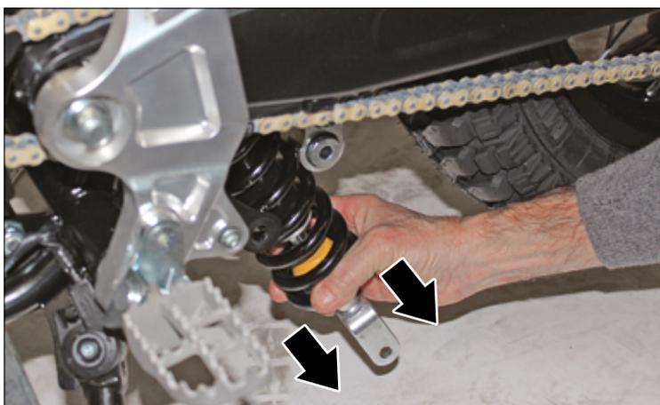
Rimuovere l'ammortizzatore dalla parte inferiore del veicolo.
