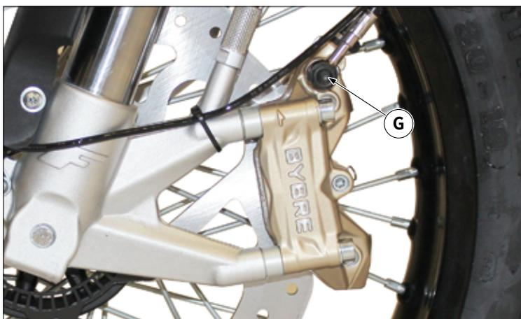
Rimuovere il raccordo tubazione impianto frenante “G” sulla pinza freno anteriore e rimuovere la tubazione.
