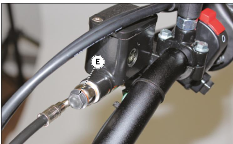
Rimuovere il raccordo tubazione impianto frenante “E” sulla pompa freno anteriore e rimuovere la tubazione.
