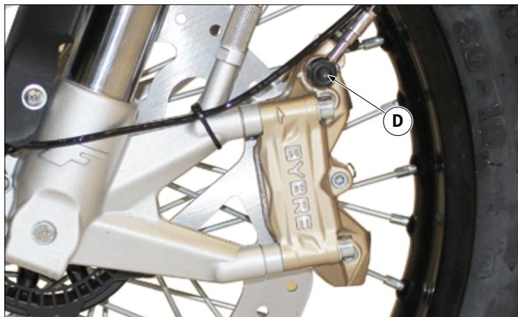
**12.18.2 Rimozione pinza freno anteriore**
