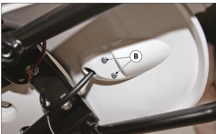
Rimuovere le viti "B" di fissaggio, poi rimuovere il faro posteriore "C".
