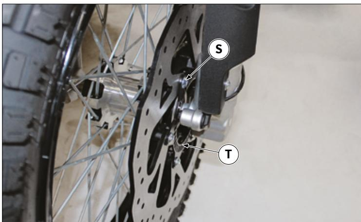
**12.19.7 Rimozione ruota fonica ABS anteriore**
