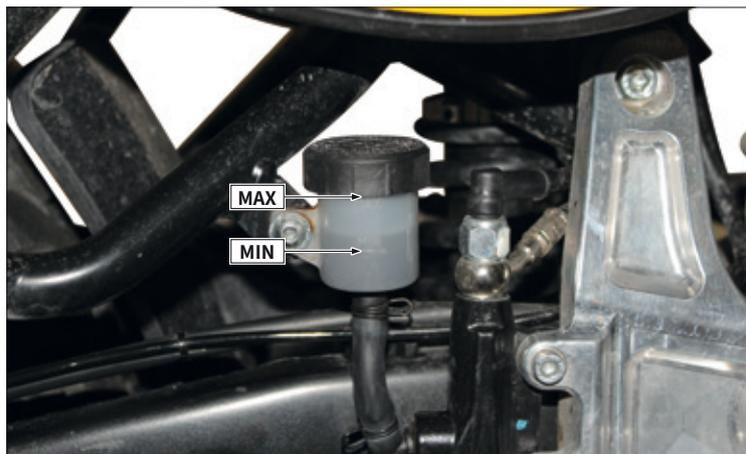
**9.5 VERIFICA LIVELLO OLIO POMPA FRENO POSTERIORE**
