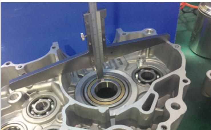
Mesurer la distance entre la bague interne du roulement du vilebrequin du demi-carter gauche et la surface d'accouplement du demi-carter gauche avec une jauge de profondeur et noter la valeur (à indiquer avec la lettre « B »).
