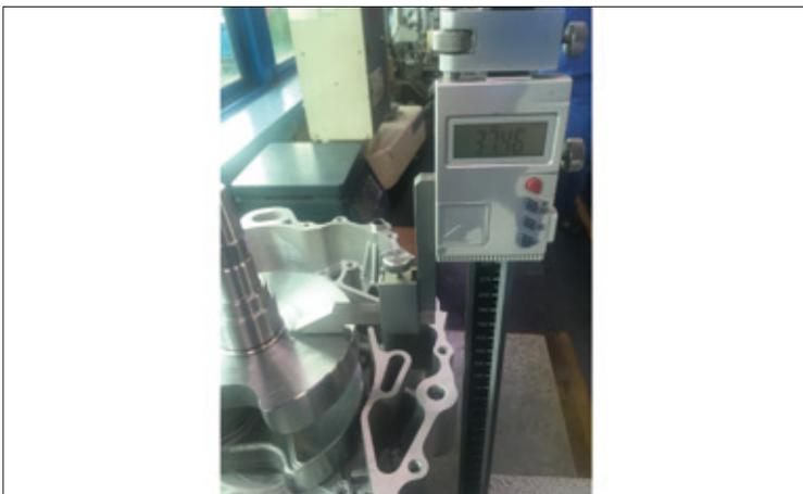
Mesurer la distance entre la surface d'accouplement du demi-carter droit et l'extrémité du bras gauche du vilebrequin à l'aide d'une jauge de hauteur et noter la valeur (à indiquer par la lettre « A »).
