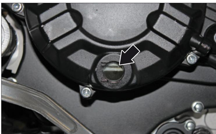
Mesurer 1 500-1 600 ml d'huile avec le gobelet mesureur et remplir le moteur par l'ouverture de remplissage avec l'huile contenue dans le gobelet en utilisant un entonnoir de remplissage, puis refermer le bouchon de l'huile.
