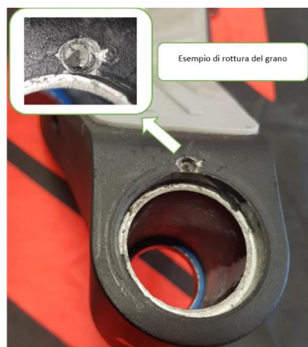
Figure 3. Exemple de rupture de la vis sans tête
