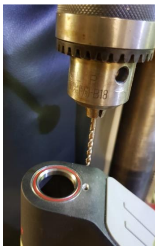
Figure 9. Perçage du nouveau trou.
