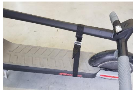
Figure 1. Scooter avec colonne de direction en position fermée Figure 2. Scooter avec sangle de maintien de la colonne de direction
