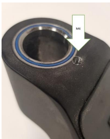
Figure 10. Exemple de nouvel usinage à partir d'un trou de M6 mm
