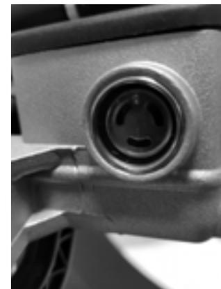
Verifica livello liquido freno posteriore Per verificare il liquido freno posteriore tenere il veicolo in posizione verticale, in modo tale che il liquido contenuto nel serbatoio olio freno sia parallelo al tappo. Verificare che il liquido sia tra i riferimenti "MIN" e "MAX".
