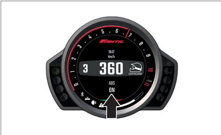
Während sich das ABS im Zustand "OFFROAD" oder "OFF" befindet, kann durch kurzes oder langes Drücken der Taste "ABS" jederzeit in den Zustand "ON" gewechselt werden. Die Neuaktivierung bewirkt, dass im Hauptinformationsfenster eine vorübergehende Pop-up-Meldung erscheint.
