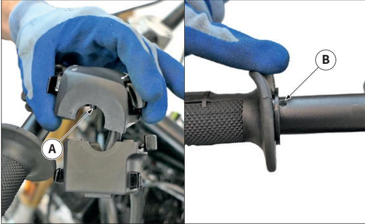
⚠ Beim Wiedereinbau darauf achten, dass der Zentrierstift "A" des Kombischalters mit dem Schlitz am Lenker "B" fluchtet.
