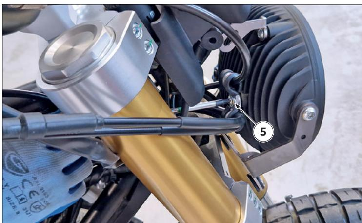
Die Schraube "5", mit der die Kabeldurchgänge befestigt sind, und die beiden Kabeldurchgänge entfernen und dann den Scheinwerfer abnehmen.
