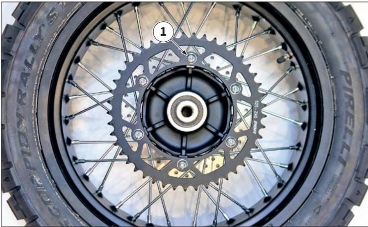
**12.13.3 Ausbau des Kettenkranzes**
