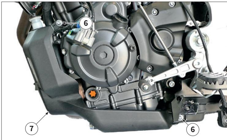
Die Schrauben "6" auf der gegenüberliegenden Seite lösen, dann den mittleren Schutz "7" entfernen.
