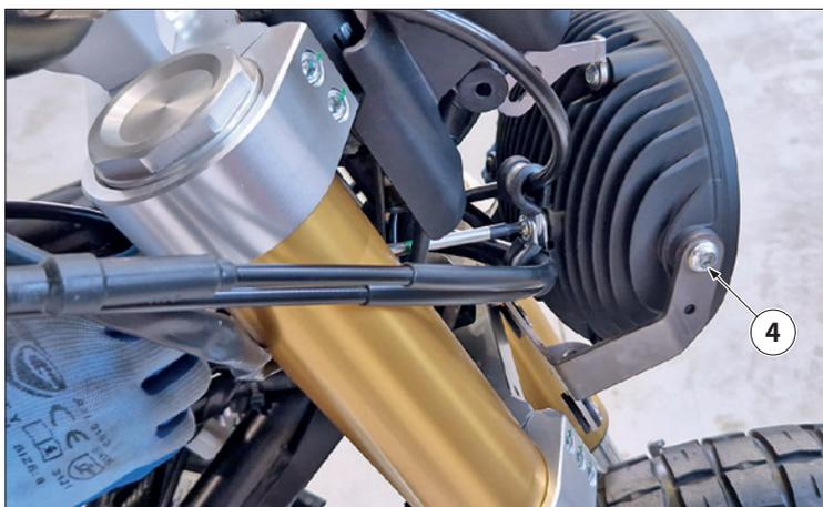
Die beiden Schrauben "4" entfernen, mit denen die Leuchte an der unteren Gabelbrücke befestigt ist.
