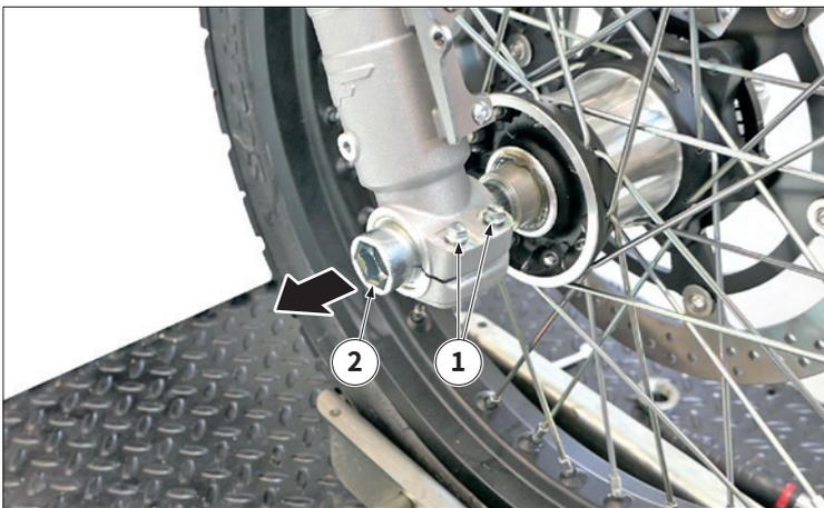
Die Schrauben "1" auf beiden Seiten lösen, dann die Radachse "2" abnehmen und das Vorderrad ausbauen.
