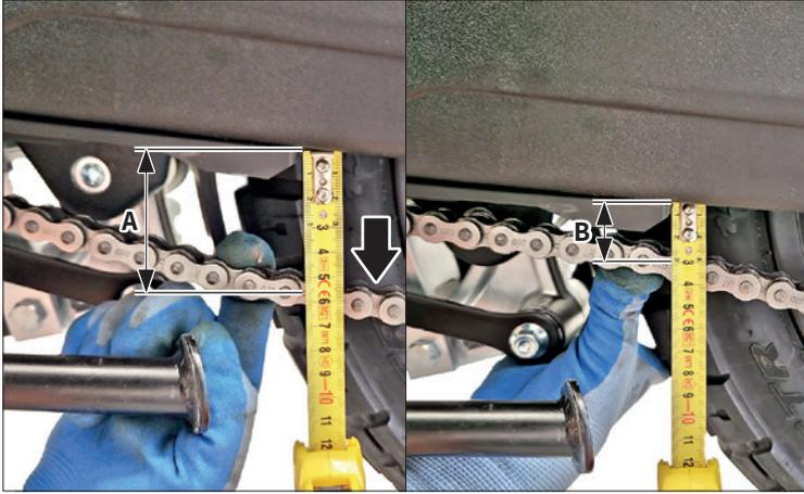
Den unteren Kettenstrang in der Mitte zwischen Ritzel und Kranz mit dem Finger zuerst nach unten und dann nach oben drücken und den Abstand von der Kante der Schwinge messen; prüfen, dass die vertikale Schwingung, die sich aus der Differenz zwischen dem höchsten Wert "A" und dem niedrigsten Wert "B" ergibt, etwa 25 mm (0,98 in) beträgt.
