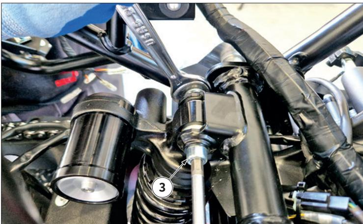
Den Stift "3" und die Sicherungsmutter von der oberen Stoßdämpferbefestigung entfernen.
