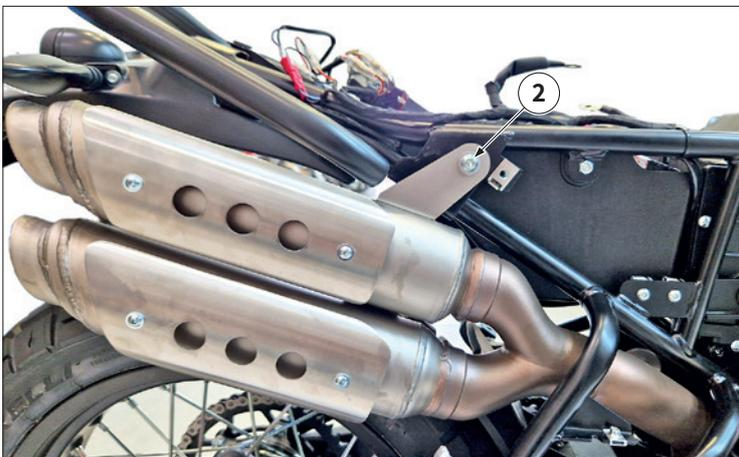
Die Schrauben "2" und den Schalldämpfer entfernen.
