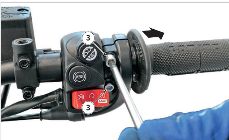
Die beiden Schrauben "3" lösen, dann den Gasdrehgriff entfernen.
