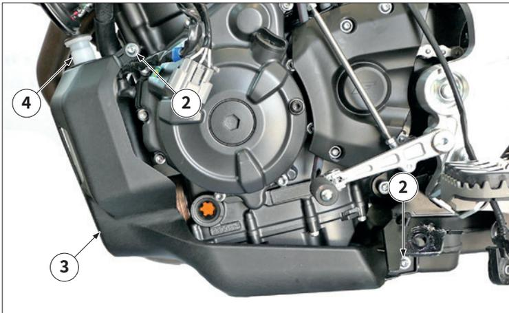
Die Schrauben "2" und die untere mittlere Abdeckung "3" entfernen, dann den Ausgleichsbehälter "4" abnehmen.
