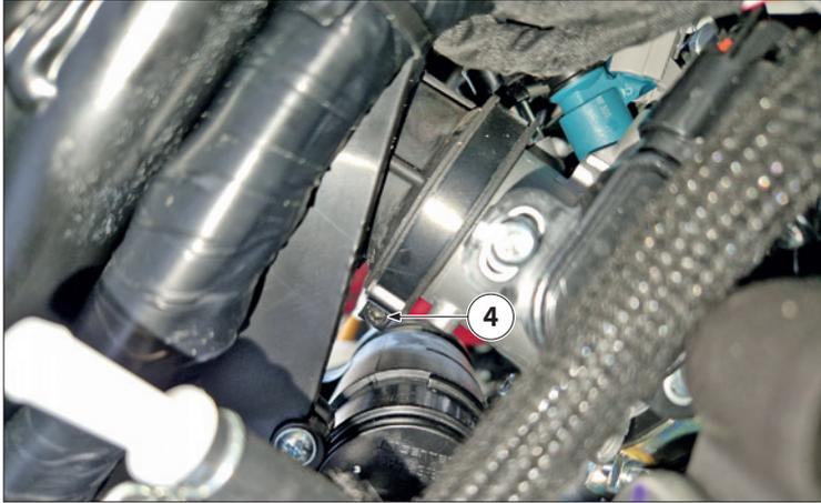
Die beiden Schellen "4" lockern, mit denen die Krümmer befestigt sind.
