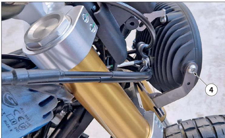
Sacar los dos tornillos "4" que fijan el faro a la placa inferior.
