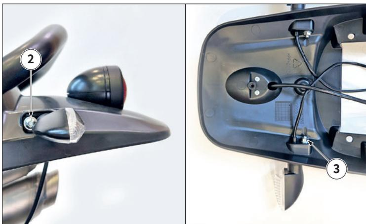
Sacar el tornillo "2" y la tuerca "3" y desmontar el indicador de dirección.
