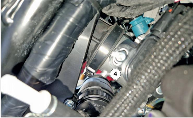
Aflojar las dos abrazaderas “4” de fijación de los colectores.
