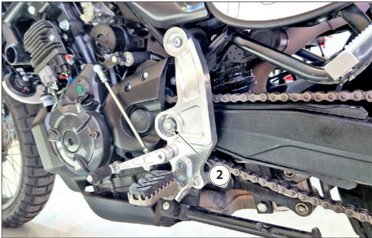
Sacar la tuerca "2" y, sosteniendo el basculante, extraer por el lado opuesto el perno "3".
