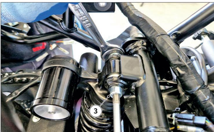
Sacar los tornillos “3” y la tuerca de bloqueo de la fijación superior del amortiguador.
