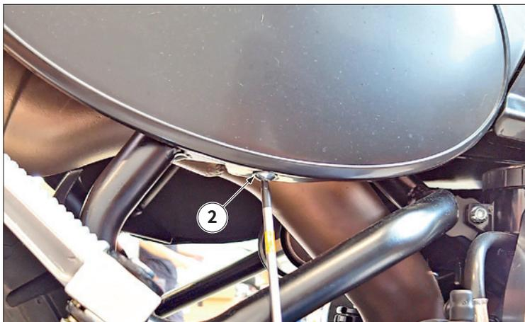
Sacar el tornillo "2" y desmontar el lateral derecho.
