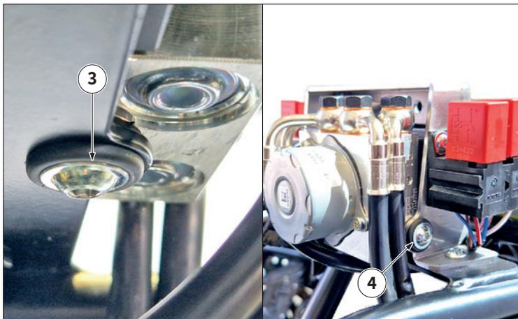
Sacar el tornillo inferior "3" y el tornillo lateral "4"; desmontar el módulo ABS.
