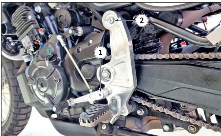
**12.15.3 Placa bastidor para pedal izquierdo del piloto**
