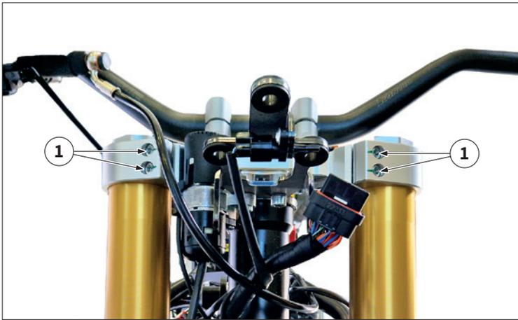
Cuando se advierta que hay juego, regularlo de la siguiente manera: Aflojar los tornillos "1" a ambos lados de la placa superior de dirección.
