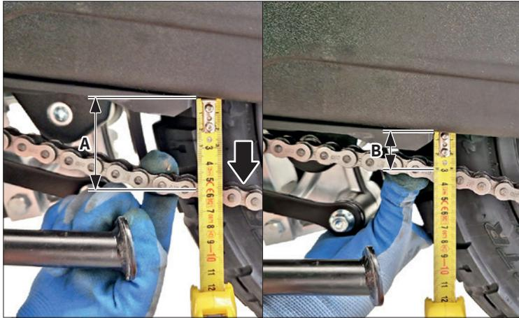
Con la sola fuerza del dedo en un punto intermedio entre el piñón y la corona, presionar el tramo inferior de la cadena primero hacia abajo y luego hacia arriba, y medir la distancia hasta el borde del basculante; comprobar que la oscilación vertical, igual a la diferencia entre el valor más alto “A” y el valor más bajo “B”.
