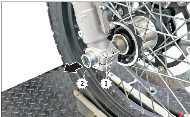
Aflojar los tornillos “1” a ambos lados, extraer el perno de la rueda “2” y desmontar la rueda delantera.
