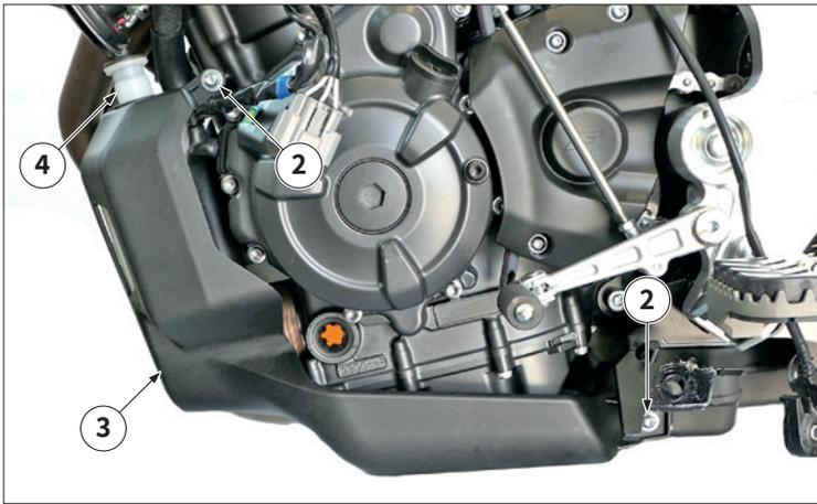
Déposer les vis « 2 » et la couverture centrale inférieure « 3 », puis déposer le vase d'expansion « 4 ».
