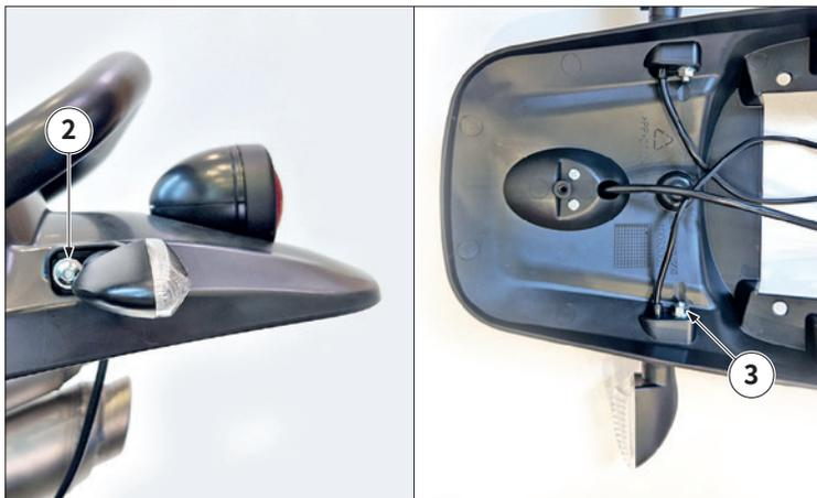
Déposer la vis « 2 » et l'écrou « 3 », puis déposer le clignotant. Répéter l'opération sur le clignotant du côté opposé.
