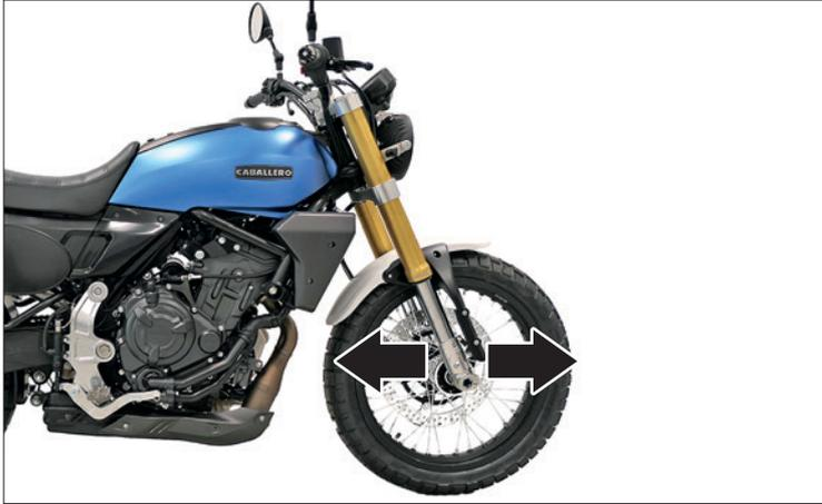
**12.11.3 Contrôle et réglage du jeu de la direction**
