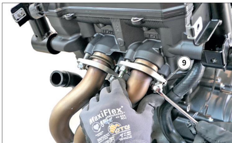
Déposer les quatre vis « 9 » de fixation du collecteur, puis déposer le collecteur.
