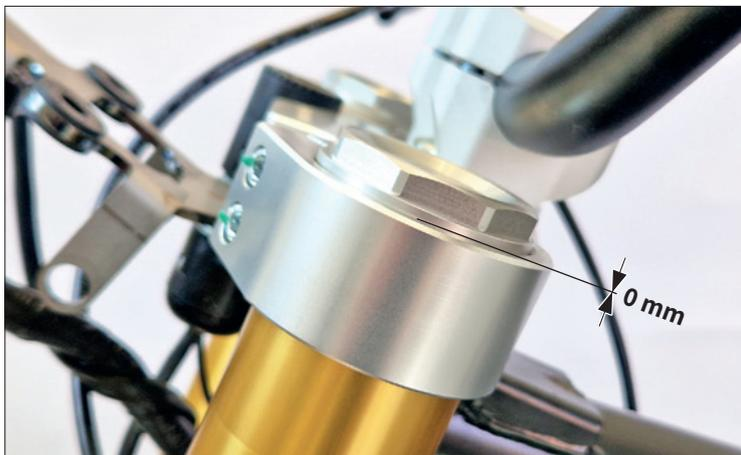
**i** Lors du remontage, s'assurer que la partie dorée supérieure des tubes de fourche est alignée sur la plaque (0 mm).
