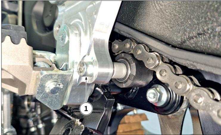
**12.13.5 Dépose du rouleau de la chaîne**
