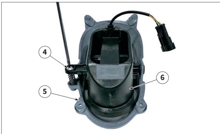
Entfernen Sie die Rücklichteinstellschraube "4" zusammen mit der Kunststoffunterlegscheibe und der Feder entfernen.
