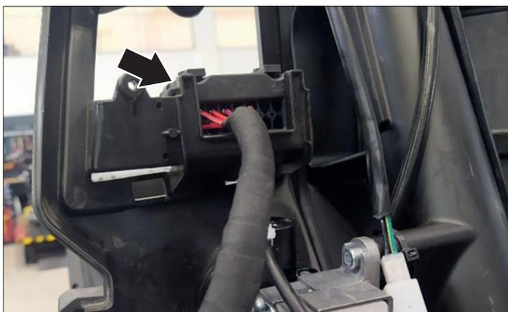
Den Sicherungskasten in den dafür vorgesehenen Sitz einsetzen.
