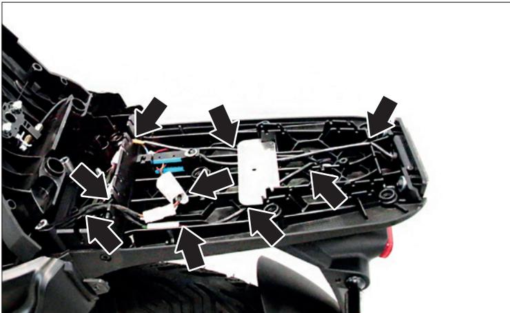
Verlegung der Kabel im Bereich des Gepäckträgers.
