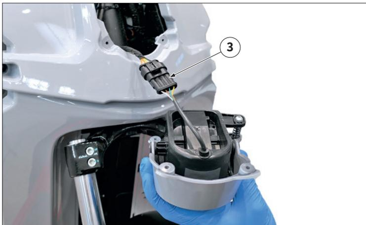
Den Steckverbinder "3" abziehen und das Rücklicht mit Abdeckung entfernen.
