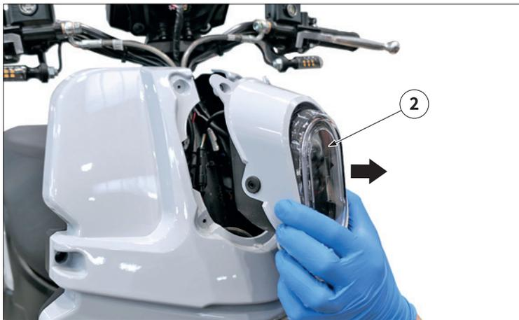
Das Rücklicht mit Abdeckung "2" entfernen.
