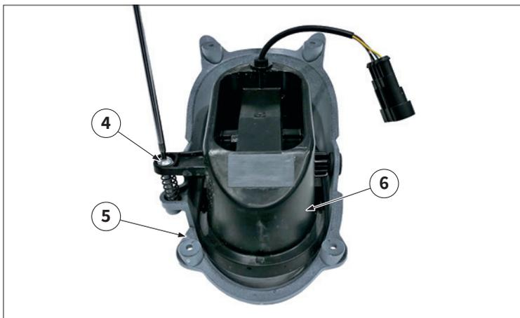
Sacar el tornillo de regulación del faro "4" junto con la arandela de plástico y el muelle.
