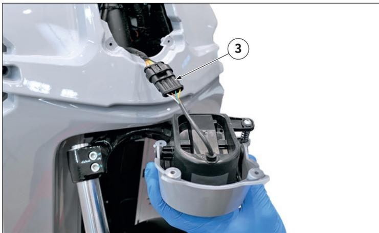
Desconectar el conector "3" y sacar el faro con la cubierta.
