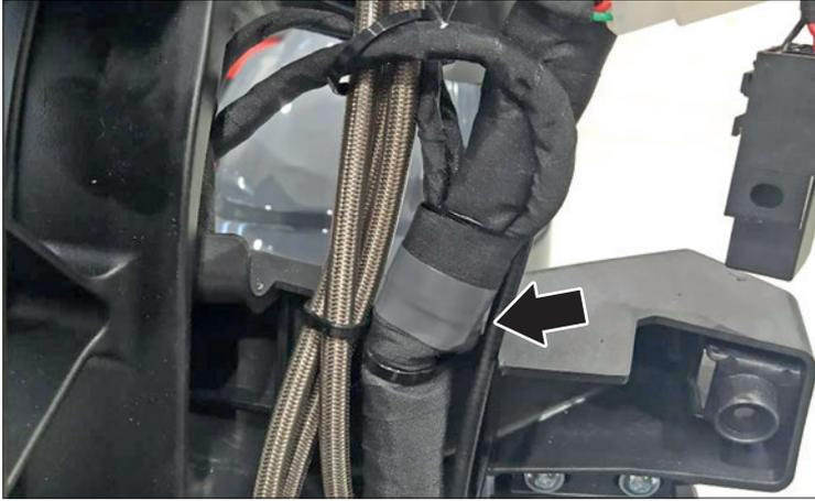
Paso del cableado del lado derecho al lado izquierdo del vehículo a través del bastidor:
