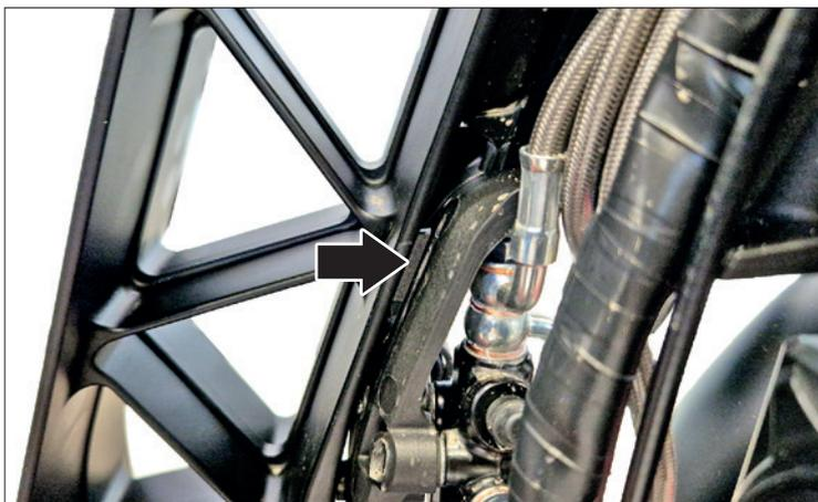
**i** Pour le remontage, procéder dans le sens inverse, en veillant à insérer correctement les deux languettes « A » dans les inserts prévus, entre le châssis et le support du bouclier avant.
