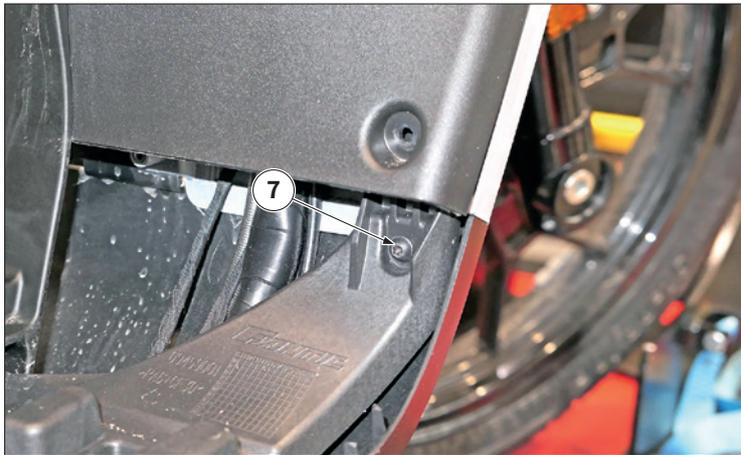
Déposer la vis autotaraudeuse « 7 » des deux côtés.
