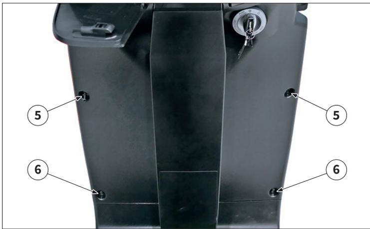
Déposer les deux vis autotaraudeuses « 5 ».
