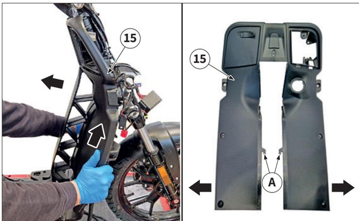
Déposer le bouclier arrière « 15 » en effectuant la procédure suivante :
