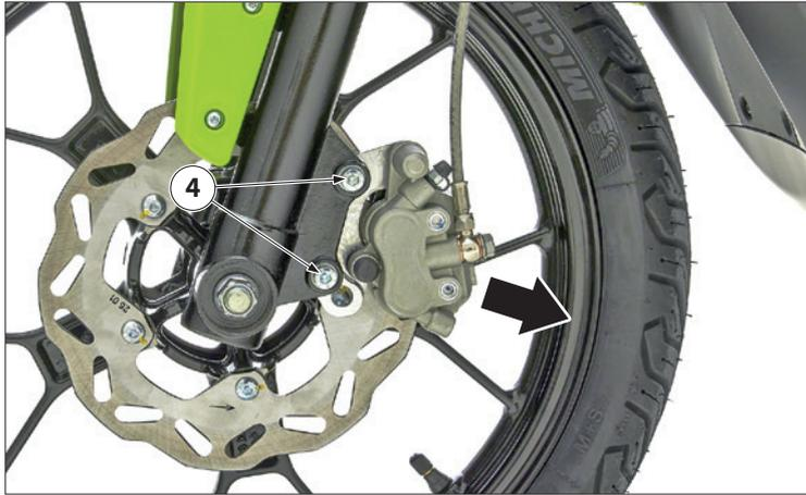
Déposer les deux vis « 4 » de fixation de l'étrier de frein à la tige de la fourche.
