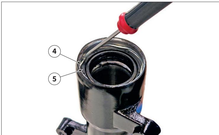
Déposer le circlip de la fourche « 4 ».
