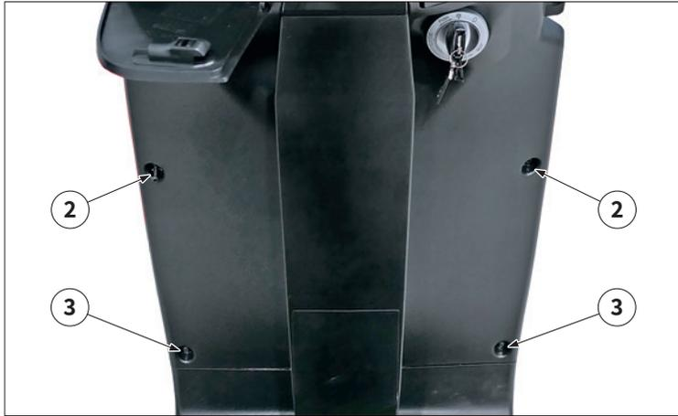
Déposer les deux vis autotaraudeuses « 2 ».
