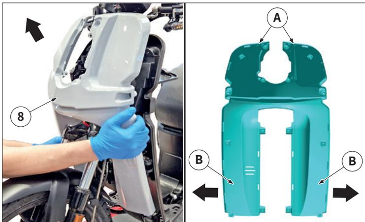
Déposer le bouclier avant « 8 » en s'assurant d'avoir décroché correctement les deux languettes « A » et d'avoir légèrement élargi les deux extrémités inférieures « B », afin que le bouclier avant puisse être facilement extrait de la fourche avant.
