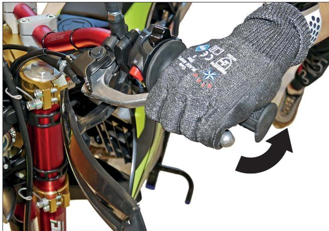
Agire energicamente con il piede sul pedale di avviamento ruotando contemporaneamente con moderazione la manopola acceleratore.
