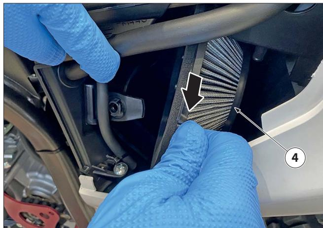
**i** IL TIPO DI FILTRO NON PREVEDE INTERVENTI DI PULIZIA MA SOLO SOSTITUZIONE che deve avvenire ogni 3000km (1750 ml) per utilizzo stradale ed almeno ogni 1000 km in caso uso fuoristrada.
