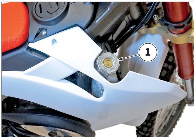
**⚠ Nell'aggiungere il liquido fare molta attenzione a non superare il “livello di pieno” altrimenti si potrebbero verificare delle fuoriuscite durante il funzionamento del veicolo e se ne potrebbe compromettere il funzionamento.**
