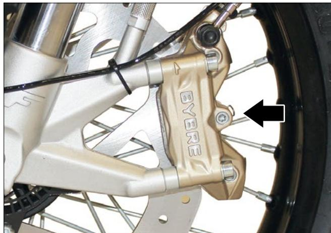
Realizar un control visual entre el disco y las pastillas, mirando de abajo hacia arriba en la dirección del eje de la rueda para las pinzas del freno delantero y de arriba hacia abajo para la pinza del freno trasero.
