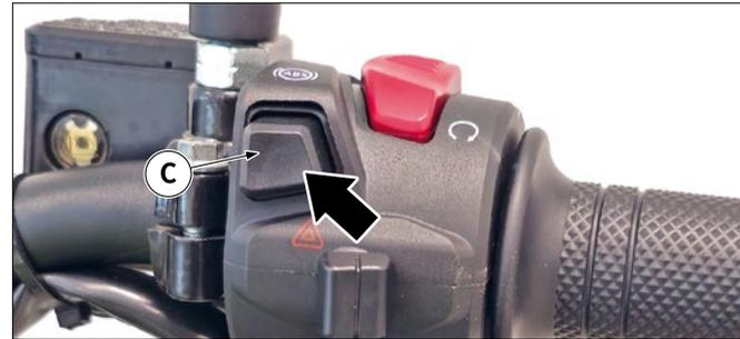
Después de un accionamiento prolongado del botón "ABS" "C" (superior a 3 segundos), el estado del ABS puede pasar a "OFF".
