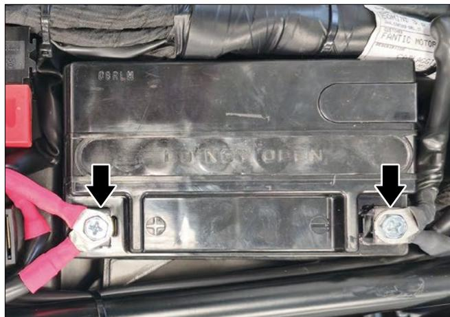
**i** En caso de uso prolongado del vehículo, se recomienda desconectar los terminales de la batería para evitar el deterioro de ésta.
