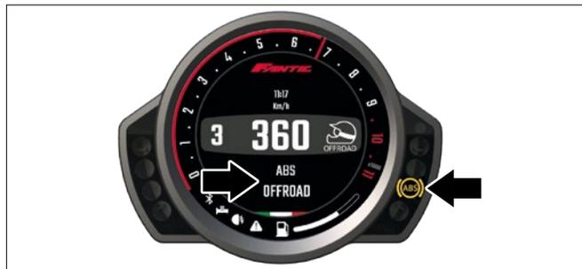
Avec l'ABS sur l'état « OFFROAD » (activé uniquement sur l'avant) ou « OFF (DÉSACTIVÉ) », un appui bref ou prolongé sur le bouton « ABS » permet de le faire passer à l'état « ON (ACTIVÉ) ». La réactivation s'accompagne d'un message qui apparaît temporairement dans la fenêtre d'information principale.
