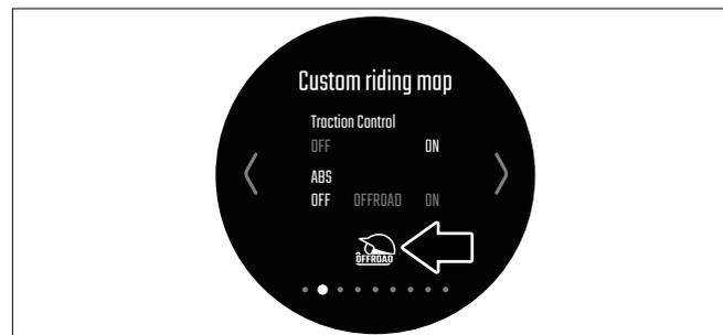
Si l'ABS est réglé sur « ON (ACTIVÉ) », le symbole représenté dans la photo ci-contre apparaît également à l'afficheur à la fermeture du menu Options.
