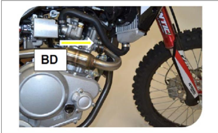
**HINWEIS: ZYLINDERKOPF, ZYLINDER, KUPPLUNG UND ZÜNDUNG KÖNNEN AUSGEBAUT WERDEN, OHNE DASS DER MOTOR VOM RAHMEN GETRENNT WERDEN MUSS. DAS MOTORRAD GRÜNDLICH REINIGEN, BEVOR MIT DEM AUSBAU BEGONNEN WIRD. DAS MOTORRAD FÜR DIE ARBEIT AUF EINE GEEIGNETE UNTERLAGE STELLEN.**
